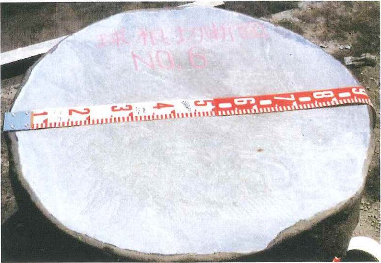
拡大球根の性状は、砂層地盤の場合の例では完全なモルタル状の密な硬化体となっております。（コア圧縮強度については、その一例として8ページに示しております。）
