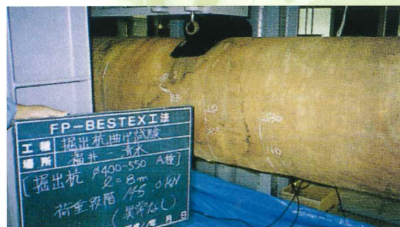
掘出しぐいの静曲げ試験
