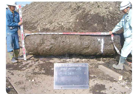
杭径φ450mm掘出試験結果
